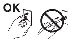
**L'appareil doit être relié à une prise avec terre.**
