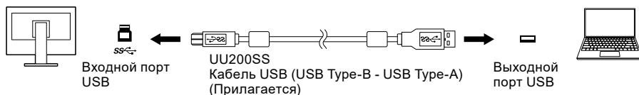
2. Соедините периферическое устройство USB с USB выходным портом ([стр. 9](#)) монитора.
