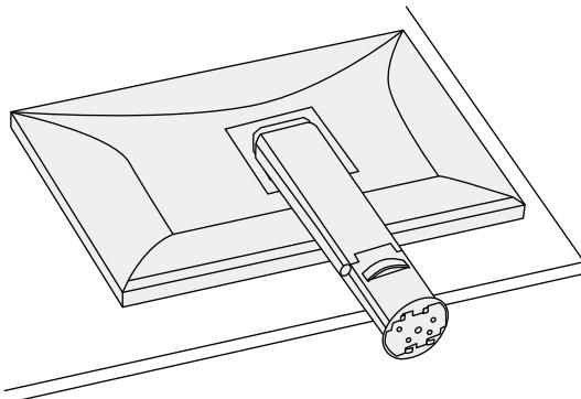
2. Возьмите основание стойки таким образом, чтобы задняя маркировка (FRONT) была выровнена, как показано на схеме, и зафиксируйте стойку на крепежной скобе.
